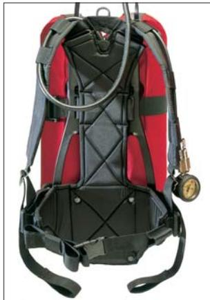
300 y 500 de Sabre incorporan un amés fabricado en Kevlar/Normex e incluyen un acolchado de espuma. Ambas aspalderas utilizan materiales que cumplen con los requerimientos de temperatura y llama de NPFA 1981, así como con los de EN 137 Clase 3.
