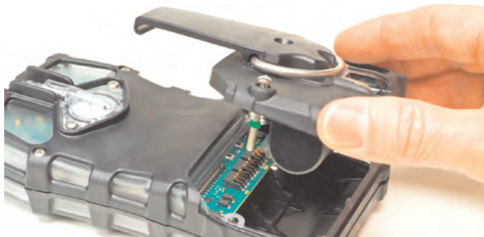
Figure 4-1. Remplacement des piles
